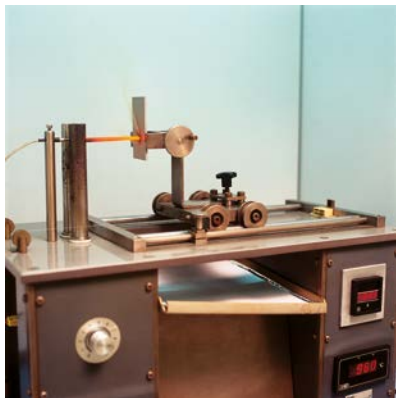
Essai au fil incandescent à 960°C s/EN 61537.
